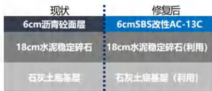
图 4.2-4 非机动车道铣刨罩面示意图
