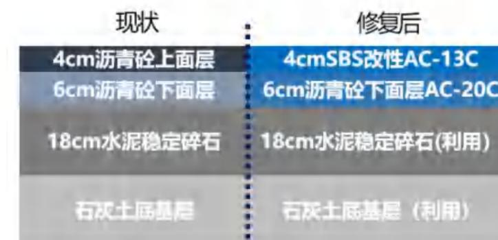
图 4.2-3 机动车道铣刨罩面示意图
